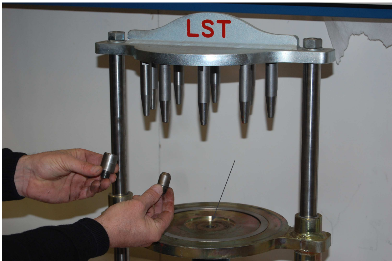
Styrebolt monteres i senter på platen. Venstre for BC ruller, høyre for A ruller.
