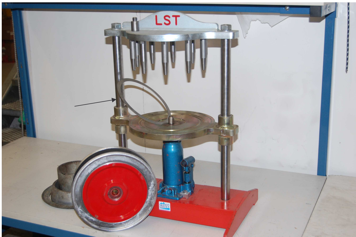
Vektrull Type A "skrueløs" Ved skifting av gumme på A ruller må den tynne distansskiven legges på platen.
